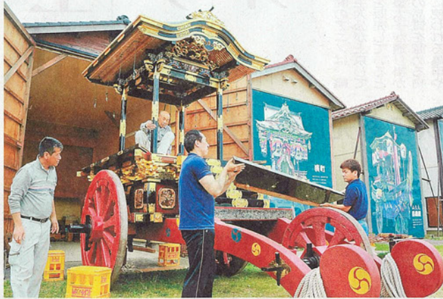
修理に向けて、美川南町の台車の部材を取り外す職人 白山市美川浜町
